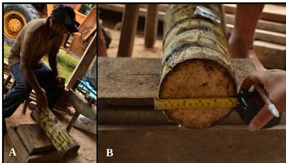
Figura 12. Mensuração da amostra. A. Pesagem. B. Medição do diâmetro.
