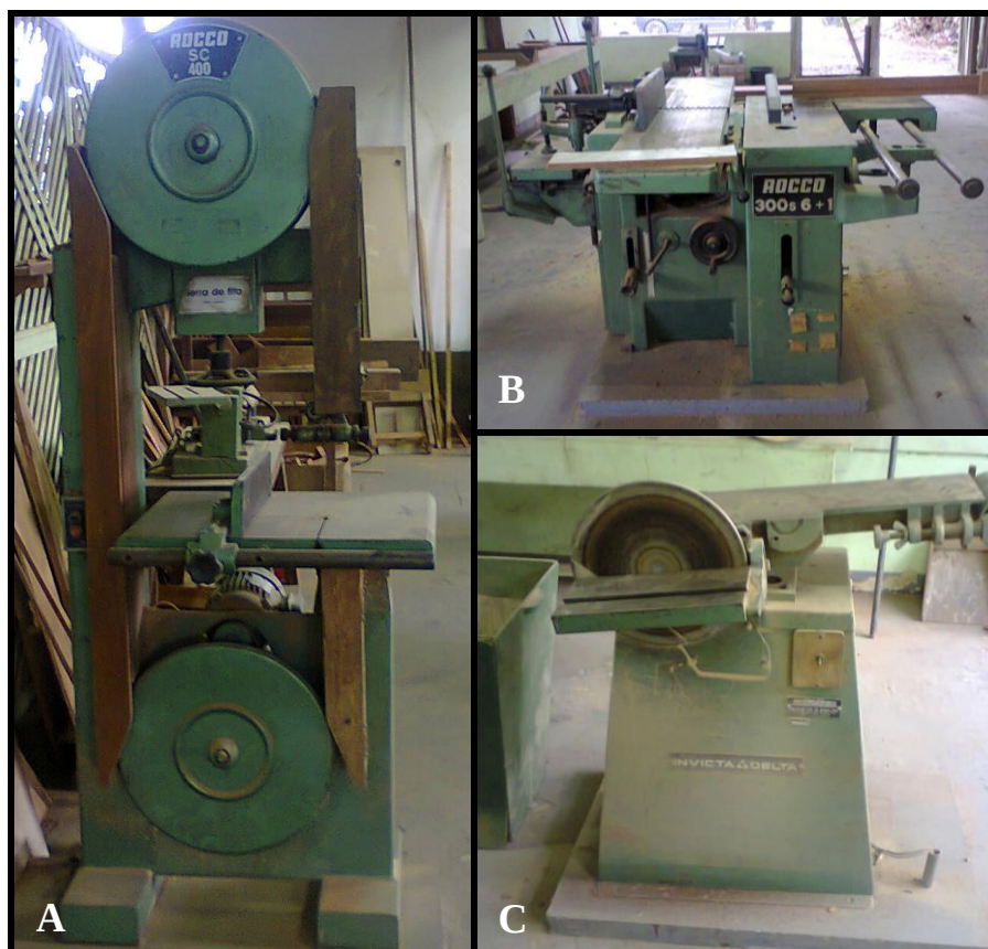
Figura 16. Maquinário utilizado no desdobro. A. Serra de fita. B. Serra circular. C. Lixadeira.
