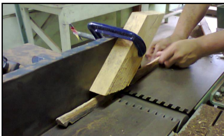
Figura 19. Adaptação na plainadeira.
