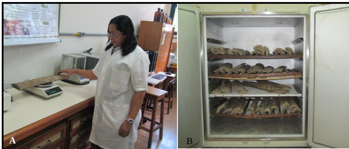
Figura 14. Método de secagem. A. Verificação da massa constante. B. Amostras na Estufa.
