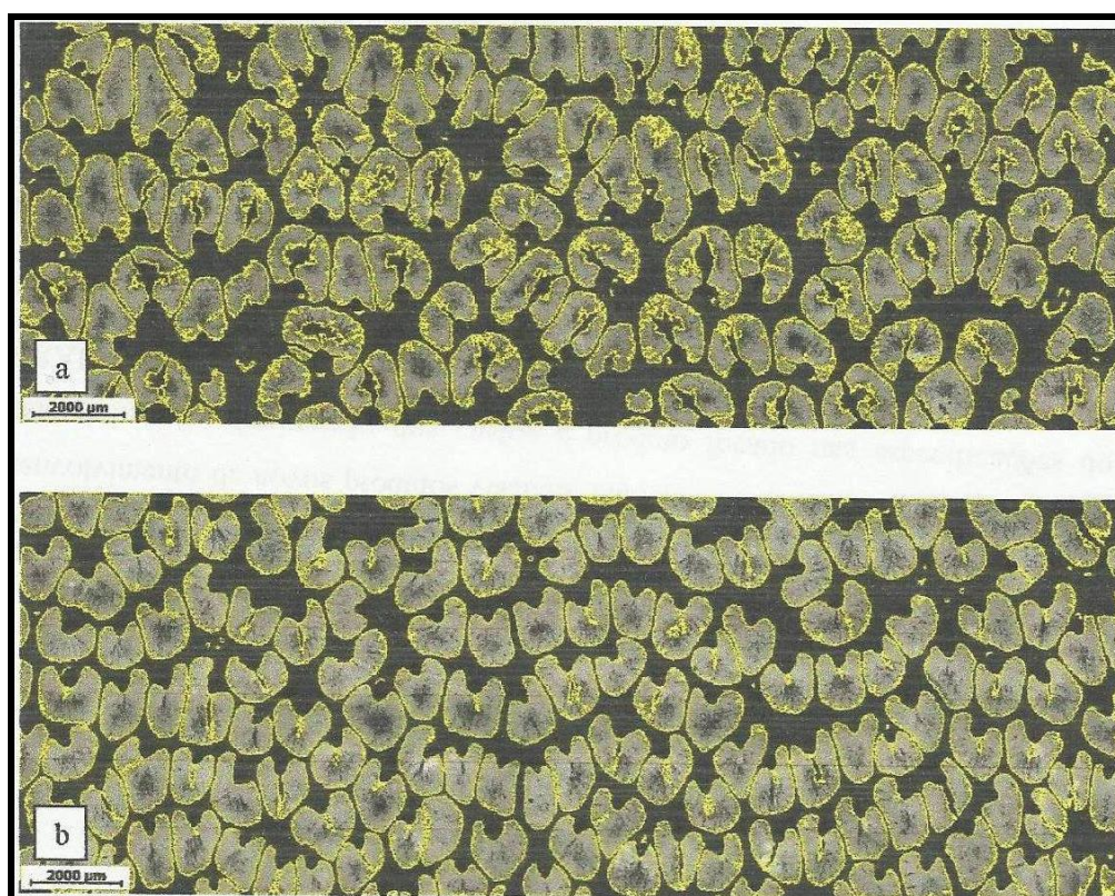
Figura 4. Mosaico (10x5) das seções transversais do estipe. A. Secção transversal do corpo de prova que a apresentou o menor valor de tensão de ruptura em flexão. B. Secção transversal do corpo de prova que a apresentou o maior valor da tensão de ruptura em flexão.
