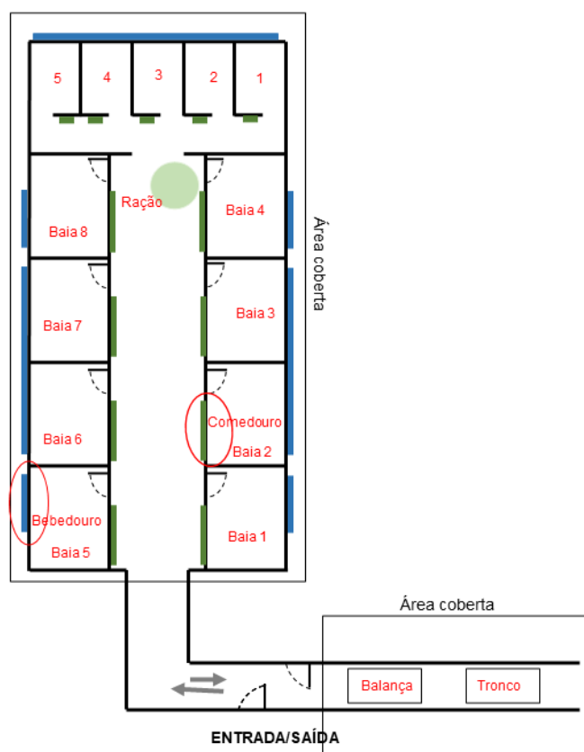
Figura 15 - Croqui da Instalação dos Ovinos
