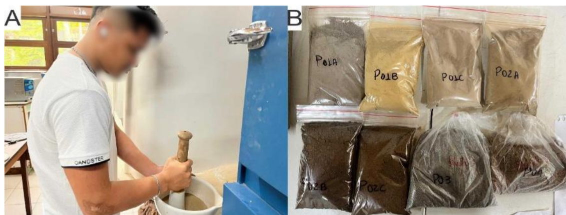
Figura 24. Preparo das amostras de solo e sedimento coletadas em campo: a) Desagregação da amostra utilizando gral de porcelana. B) Amostras já preparadas para serem levadas ao granulômetro à laser.
