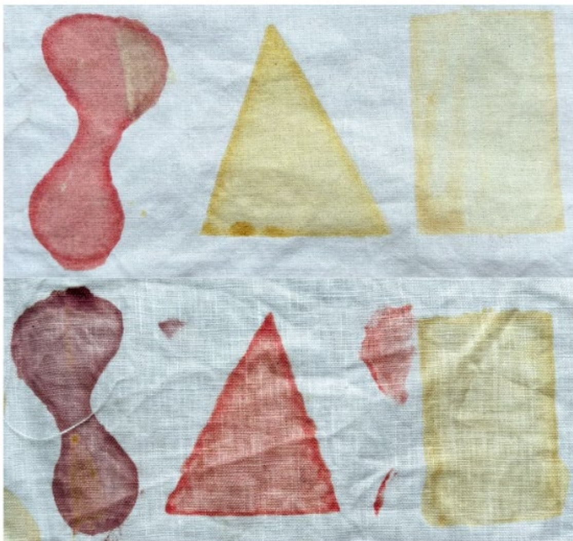
Figura 45. Testes das tintas com moldes vazados realizados no tecido 1 (100% algodão) e 3 (100% linho), respectivamente. Fonte: A autora (2025).
