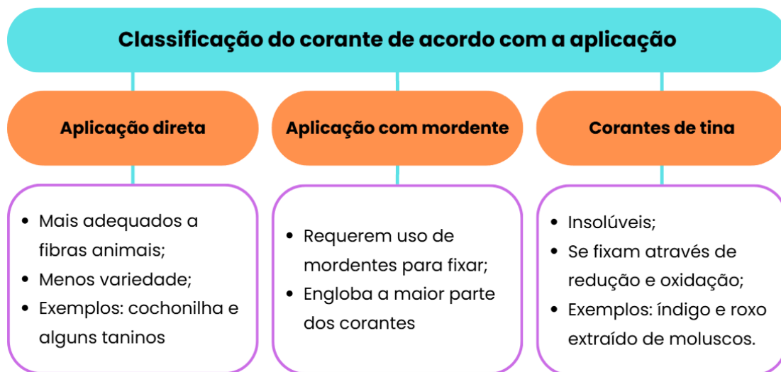
Figura 12. Classificação dos corantes. Fonte: Adaptado de Boutrup e Ellis (2018).
