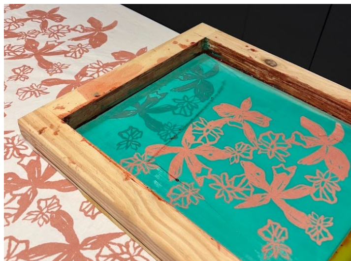
Figura 58. Estampagem do tricoline com matriz serigráfica e tinta 2 de cajúru. Fonte: A autora (2025).
