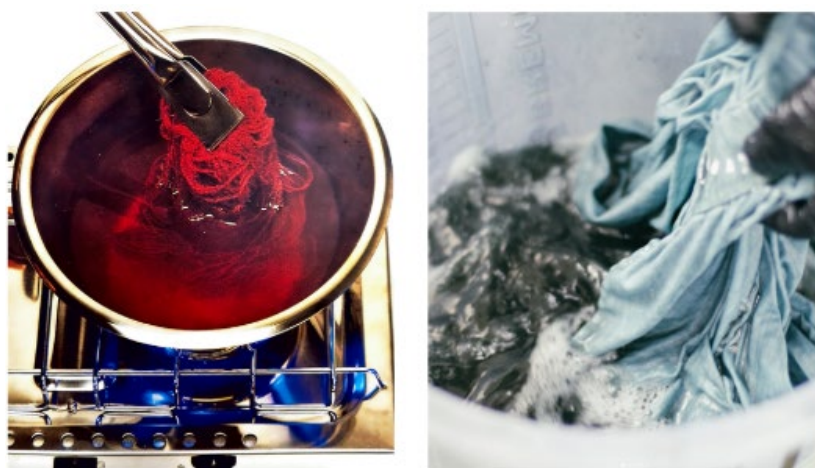
Figura 13. Imersão em banho quente com corante vermelho e azul. Fonte: Dean, 2010 e Perfil do Instagram da estilista Flávia Aranha. Disponível em: http://www.instagram.com/flaviaaranha_ . Acesso em: 31 out. 2024.
