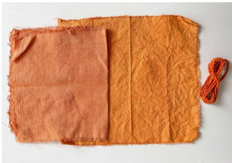
Figura 9. Tecido de linho, algodão e fio de algodão tingidos com sementes de Urucum ( Bixa orellana ) secas e frescas, sem uso de mordentes. Fonte: A autora (2024).
