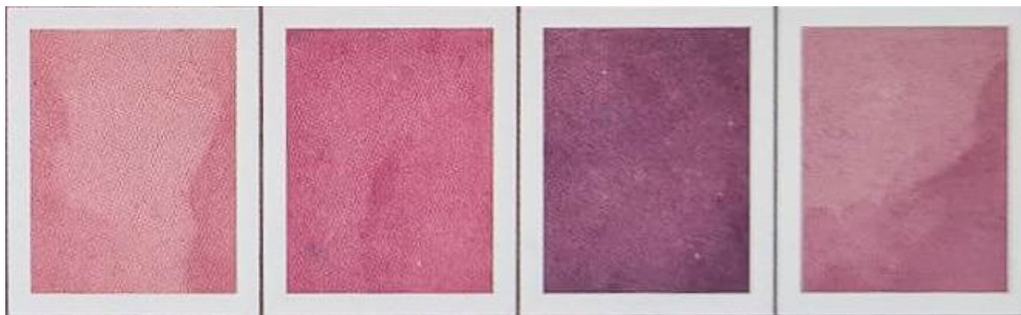
Figura 15. Variações de cores do crajiru obtidas com sulfato ferroso e alúmen. Fonte: Extraído de Maroccolo, 2024.
