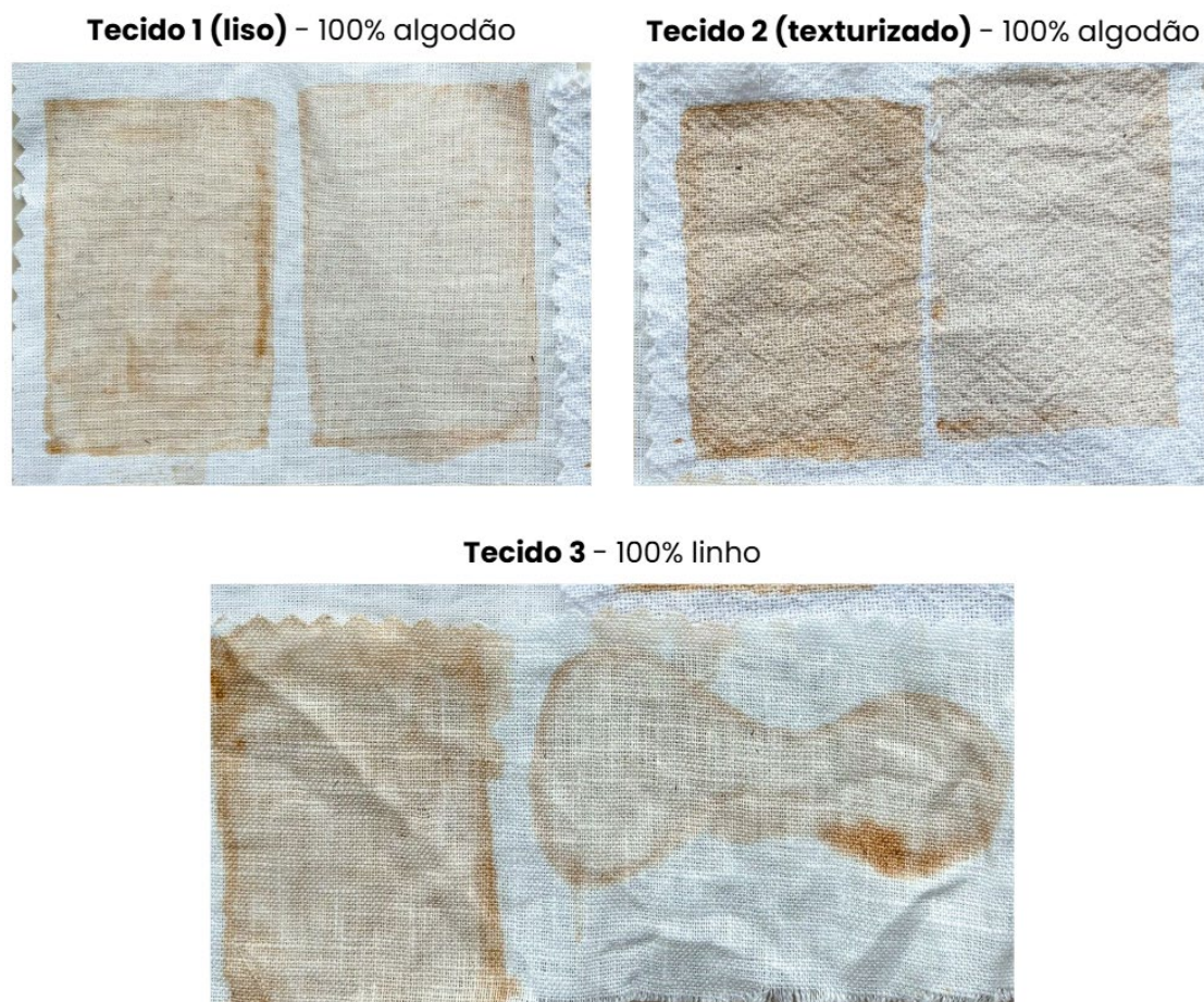
Figura 44. 1. Tinta de uxi amarelo com bicarbonato de sódio + alúmen (esquerda) e apenas alúmen (direita), em cada amostra de tecido.
