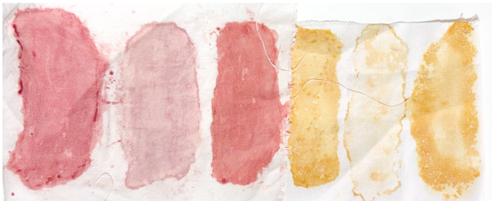
Figura 51. Tintas de crajiru e unha-de-gato após a lavagem, no meio foi adicionado bicarbonato de sódio à tinta. Fonte: A autora (2025).
