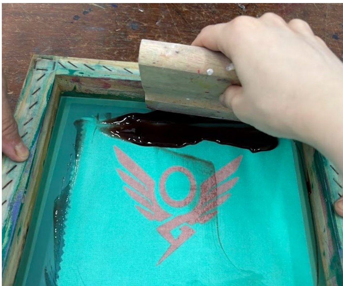
Figura 48. Tinta de cajuira com bicarbonato de sódio aplicada sob desenho chapado no tecido de algodão texturizado. Fonte: A autora (2025).
