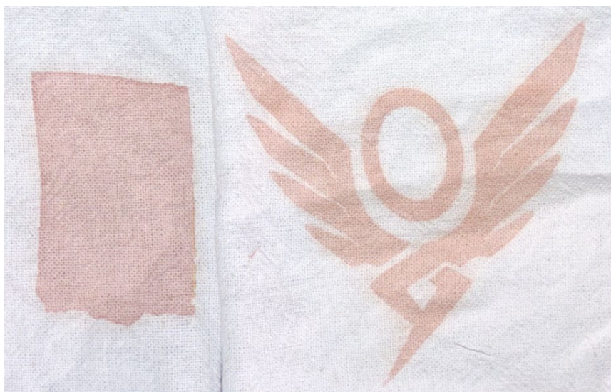
Figura 52. Resultado da tinta de crajiru com bicarbonato de sódio após lavagem. Fonte: A autora (2025).
