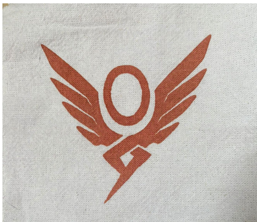
Figura 50. Resultado da tinta de crajiro sob desenho chapado no tecido de algodão texturizado. Fonte: A autora (2025).
