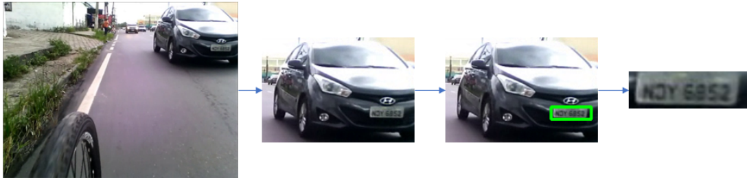
Figura 4.3: Processo de detecção da placa do veículo.
