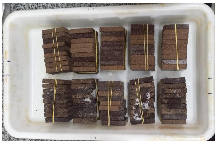
Figura 35:Corpos de prova produzidos com resíduo de andiroba tratado e não tratado após armazenamento.
