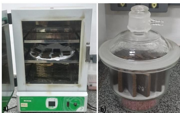
Figura 16 – Determinação do Teor de umidade (a) Estufa para secagem das amostras; (b) Dessecador para estabilização das amostras.
