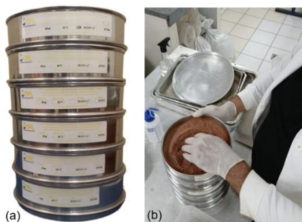
Figura 10 – a) Peneiras granulométricas da série Tyler; b) Peneiramento manual dos resíduos.
