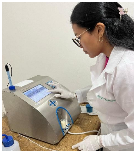
Figura 4. Realização de análise físico-química no equipamento Lactoscan.
