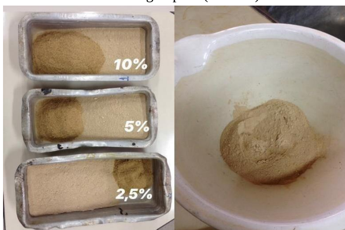
Figura 20 – Massas cerâmicas formuladas com as adições dos resíduos nas proporções de 2,5%, 5% e 10% e argila pura (ARG-A)
