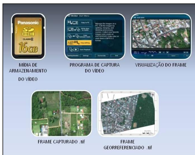
Figura 38 - Esquema de captura dos frames.
