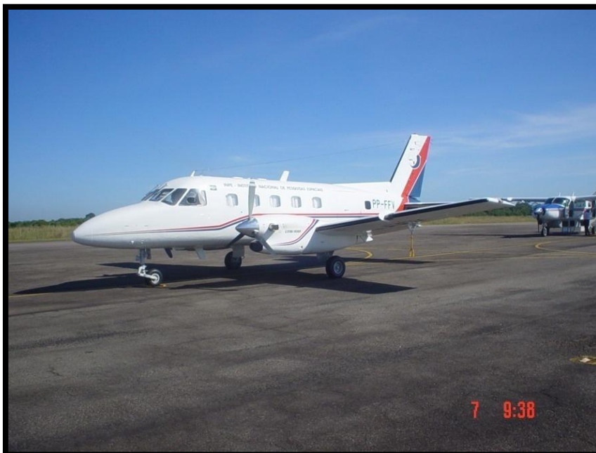
Figura 9 - Avião Bandeirante do INPE, usado em videografia aérea.
