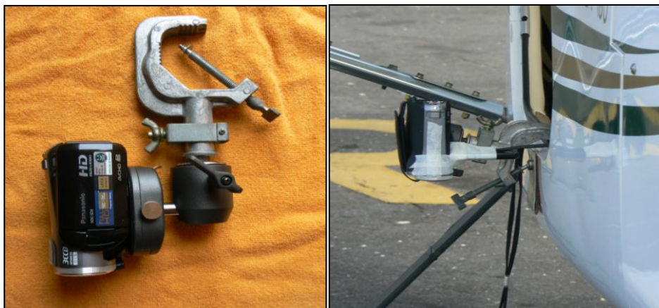
Figura 28 - Visão geral do setup. (a) Suporte e filmadora (b) conjunto acoplado na aeronave.
