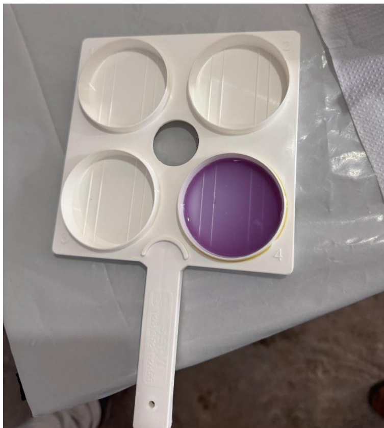
Figura 6: teste positivo de CMT na raquete coloração roxo Fonte: arquivo pessoal (2024).
