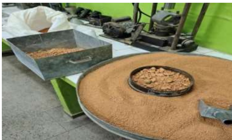
Figura 4. Preparação das Amostras de Solo para Ensaios Geotécnicos
