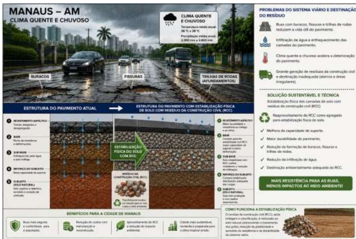
Figura 1. Relação entre as condições climáticas da Amazônia, os problemas de pavimentação e a estabilização física do solo com RCC
