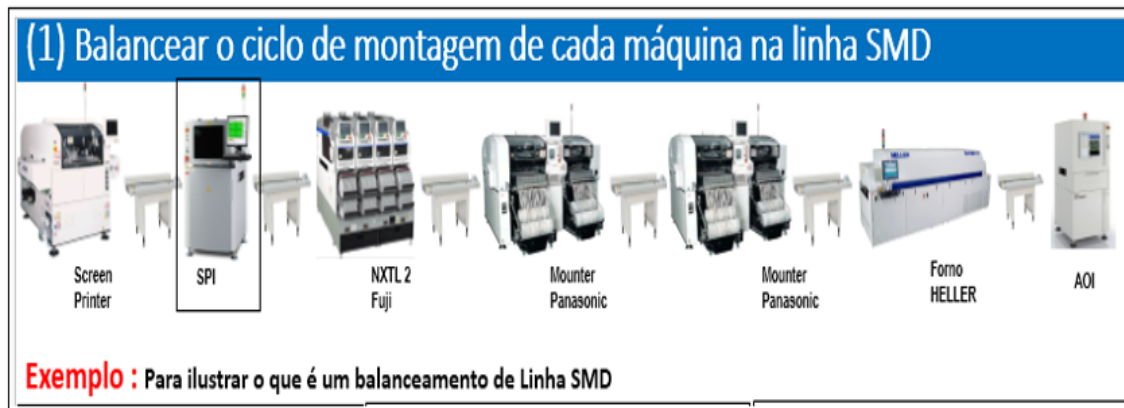
Figura 30 - Nova Disposição da Linha SMD
