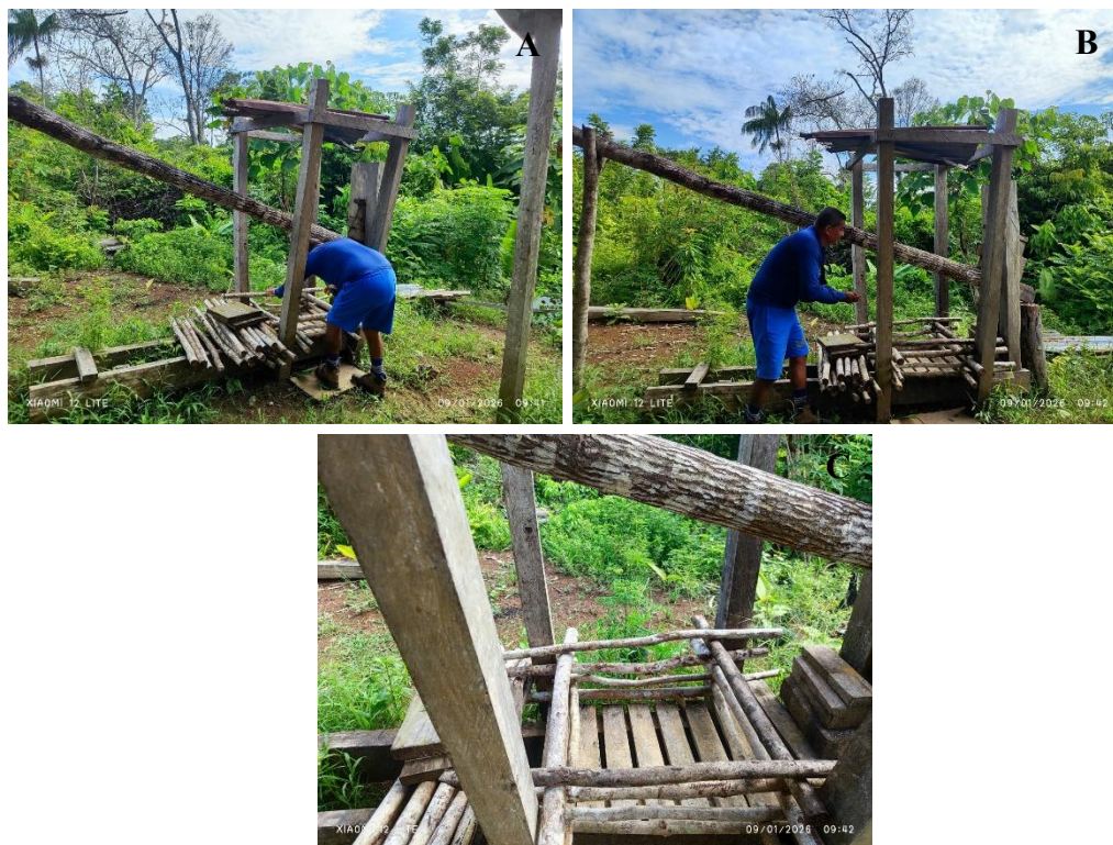
Figura 11 – Prensa artesanal utilizada na prensagem da massa de mandioca registrada na propriedade de um dos agricultores durante as turnês guiadas: (A) e (B) montagem da estrutura; (C) prensa pronta para uso
