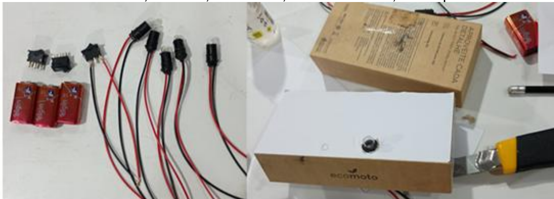
Figura 10- Componentes essenciais do circuito elétrico utilizados para a confecção dos modelos dos circuitos; baterias, bombilhos, fios condutores, interruptores.
